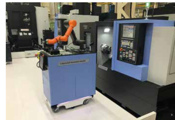
Tijdens de DIMF presenteerde Doosan een cobot op een AGV die een product vanuit een Lynx draaimachine naar een DNM bewerkingscentrum bracht. Ook de logistiek is te automatiseren
