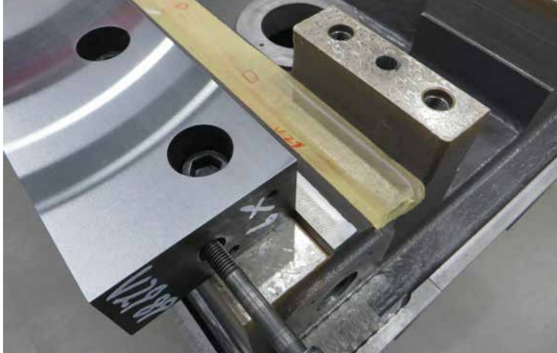
Een detailfoto van een machineframe in de montage bij Yasda. Zichtbaar is het handgeschraapte oplegvlak onder de geslepen en gelepte blokgeleiding. Rechtsboven een handgeschraapt montagevlak
