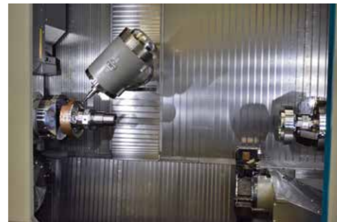
Het G420 draai-freescentrum is ontwikkeld voor de compleetbewerking van onderdelen voor onder andere de machinebouw, de luchtvaart- en de landbouwindustrie
