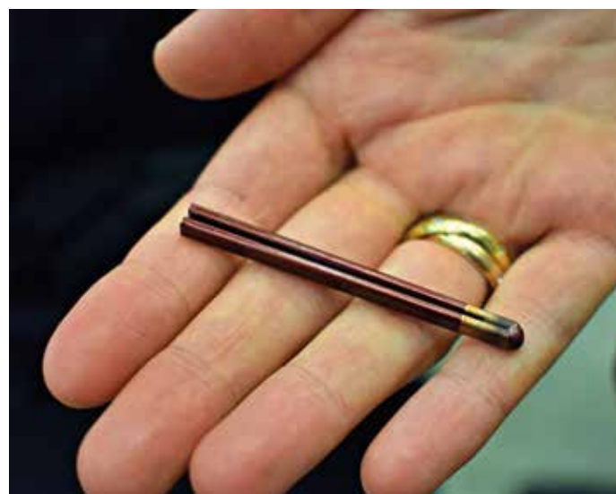
Voorbeeld van een koperen hairpin die aan het uiteinde met een laserlas wordt verbonden
