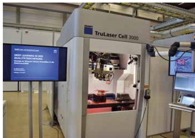
Met deep learning wordt kunstmatige intelligentie in het kwaliteitsproces gebracht. Met de TruLaser Cell 3000 worden hairpins gelast voor in elektromotoren
