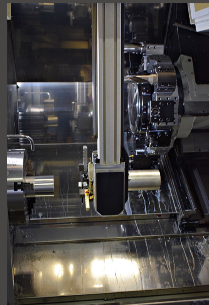
De CMZ Gantry Loader GL20II belaaft en ontlaadt de bewerkingsmachine met een gripper, die via een gantry pendelt tussen de bewerkingsruimte van de machine en het palletmagazijn
