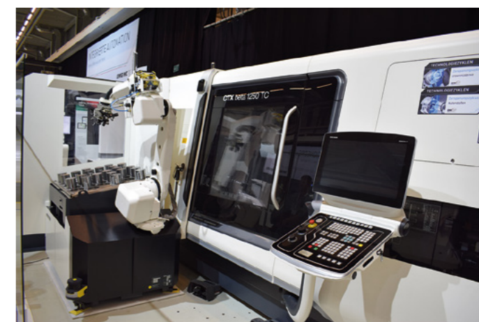
De Robo2Go maakt het mogelijk om CNC-draaibanken te automatiseren
