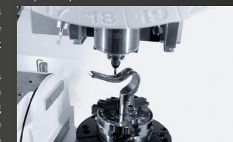
De nieuwe DMP 70 is een compact bewerkingscentrum. De geïntegreerde draai-zwenktafel maakt vijffasige simultaanbewerking mogelijk (foto: DMG Mori)
