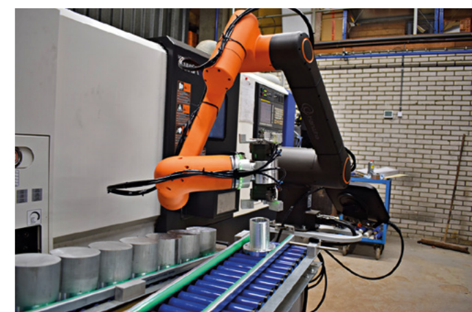
Dankzij de ingebouwde veiligheid kan de cobot zonder veiligheidshekken bij de machine werken. Dit scheelt een hoop ruimte
