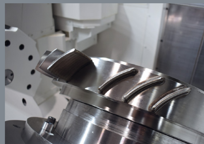
Door frezen, draaien, slijpen, harden en laseroplassen te combineren in één machine, wordt het aantal omspannen van het werkstuk sterk gereduceerd
