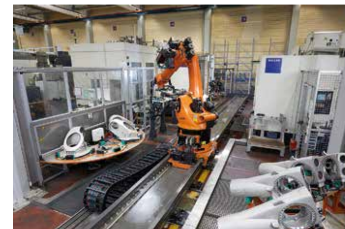
Volautomatische robotcellen gekoppeld met nauwkeurige, genetwerkte bewerkingscentra zijn de toekomst van de productie-industrie (Foto: AMB)
