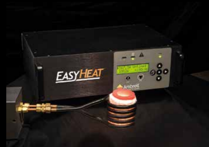
De EASYHEAT is met een vermogen van 1 kW-10 kW en frequenties van 150-400 kHz geschikt voor kleinere producten
