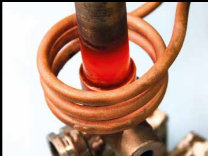
Inductieverwarming wordt bijvoorbeeld toegepast voor solderen
