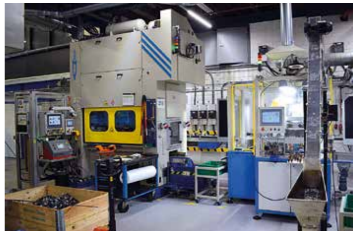
Automatisering en oplossingen om sneller om te stellen zijn belangrijke trends bij producenten. Links op de foto de pers en rechts de automatiseringscel die moertjes op beugels last
