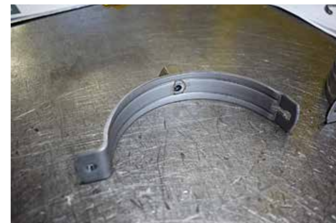
Deze beugel komt kant en klaar van de stanslijn
